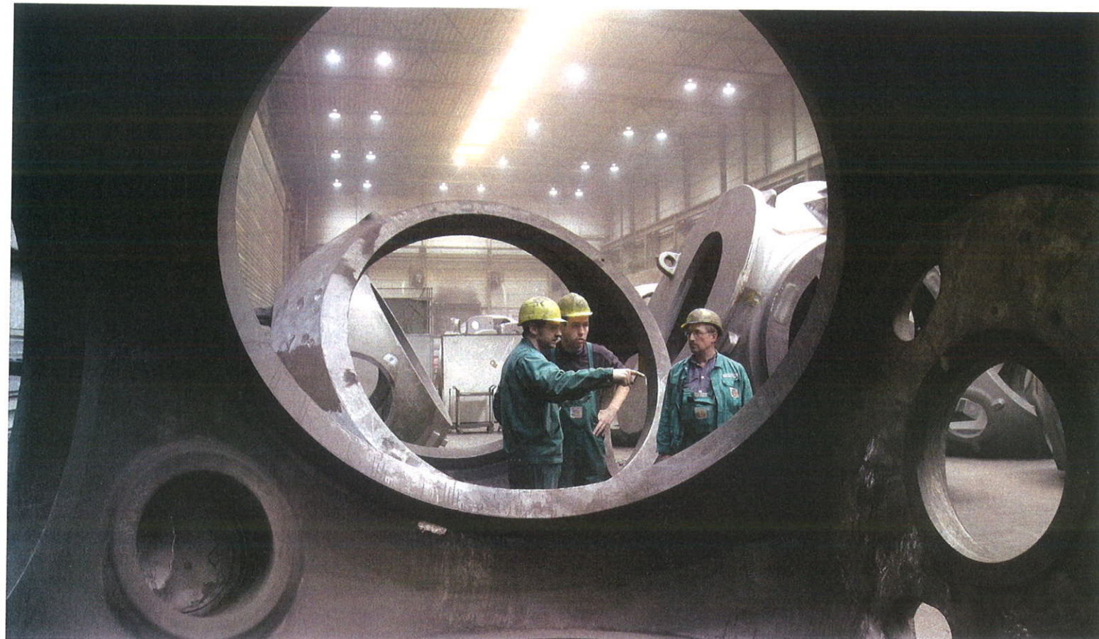
Bild 2: In Torgelow werden u. a. Rotornaben, Rahmen oder Getriebegehäuse für Windkraftanlagen gegossen.
